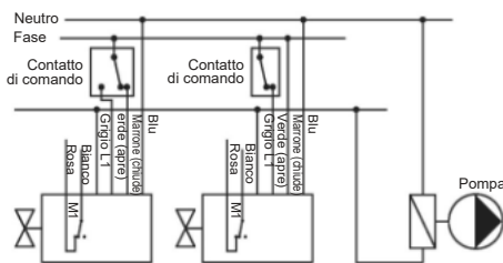
M1 MICROINTERRUTTORE SUPPLEMENTARE LIBERO IN APERTURA Collegamento del fermo pompa con un servocomando 3 punti ed uno 2 punti
